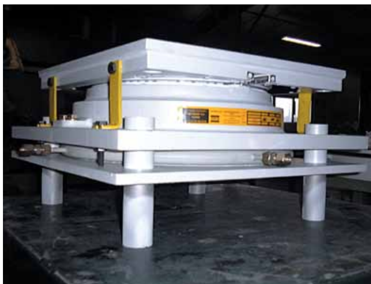
Most přes řeku Some - Švýcarsko: hrncové ložisko osazené na talířovém lisu
